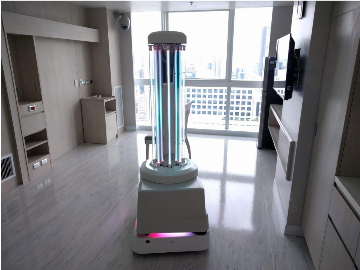
Robot autónomo que puede desinfectar hospitales mediante luz UV.
