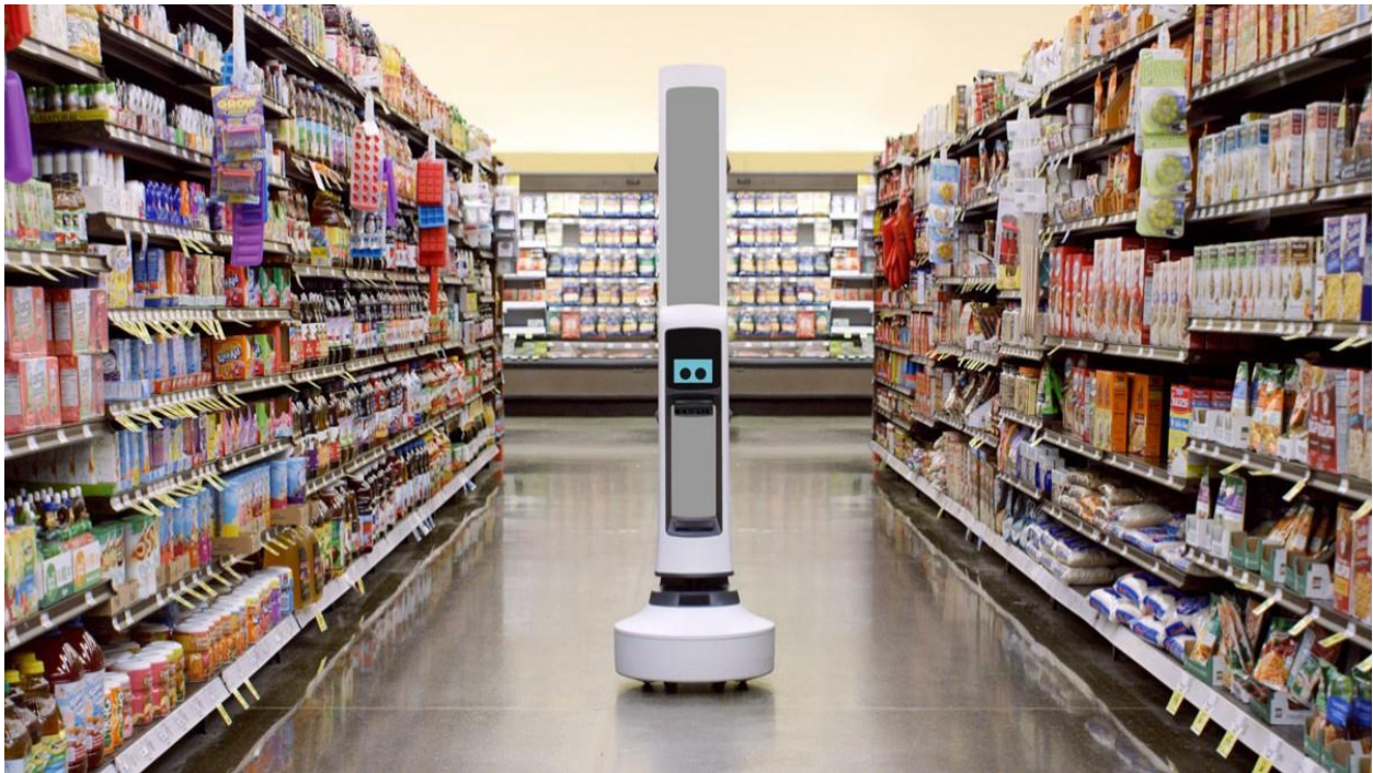
Robot autónomo que puede desinfectar todo tipo de materiales de los envases de los productos del supermercado mediante luz UV.
