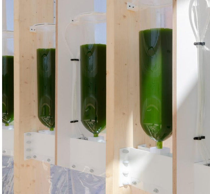
Interior de los biorreactores con algas que consumen el dióxido de carbón y los contaminantes creando oxígeno mediante fotosíntesis.
